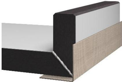
Abbildung 18: Aufkantung hochklappen und mit einem Klebeband befestigen
