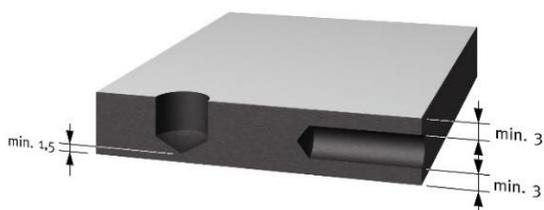
Abbildung 5: Mindestabstände der Bohrlöcher zum Plattenrand
