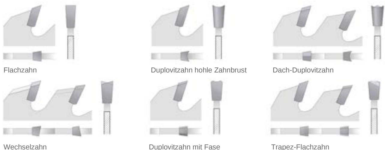
Abbildung 7: Beispiele für übliche Zahnformen von Sägeblättern
