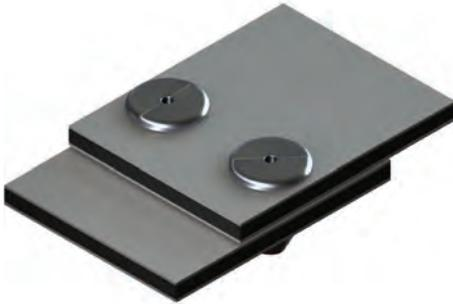
ALUPANEL® Verbundplatten können mit Hilfe von Nieten oder Blindnieten verbunden werden. Bei Außenanwendungen beachten Sie bitte den Wärmeausdehnungsfaktor.
