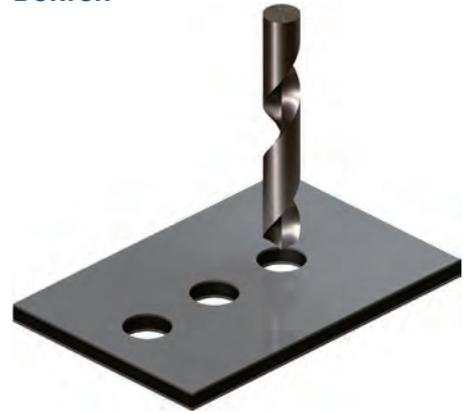
ALUPANEL® Verbundplatten können einfach gebohrt werden. Verwenden Sie für beste Ergebnisse Bohrspitzen, die speziell zum Bohren von Aluminium und Kunststoff entwickelt wurden. Für große Löcher ist eine Bohrspitze mit Hilfsmarkierung erforderlich.
