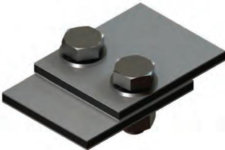
3 mm und 4 mm dicke ALUPANEL® Verbundplatten können mit einer gezackten Eckverbindung und Laschen festgeklemmt werden. Bei der Verschraubung gilt die Formel  $e=2D$  (der Mindestabstand der Bohrung muss mind. 2x der Plattenstärke entsprechen) für die Berechnung des Befestigungsabstands zum Plattenende. Für die Verwendung im Außenbereich lesen Sie bitte unser Wärmeausdehnungsdokument durch.
