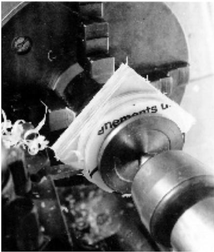
Abb. 30: Scheiben-Runddrehen zwischen Spannfutter und Reitstock
