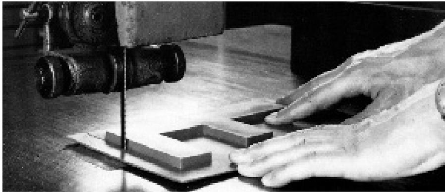
Abb. 7: Trennschnitt mit Bandsäge
