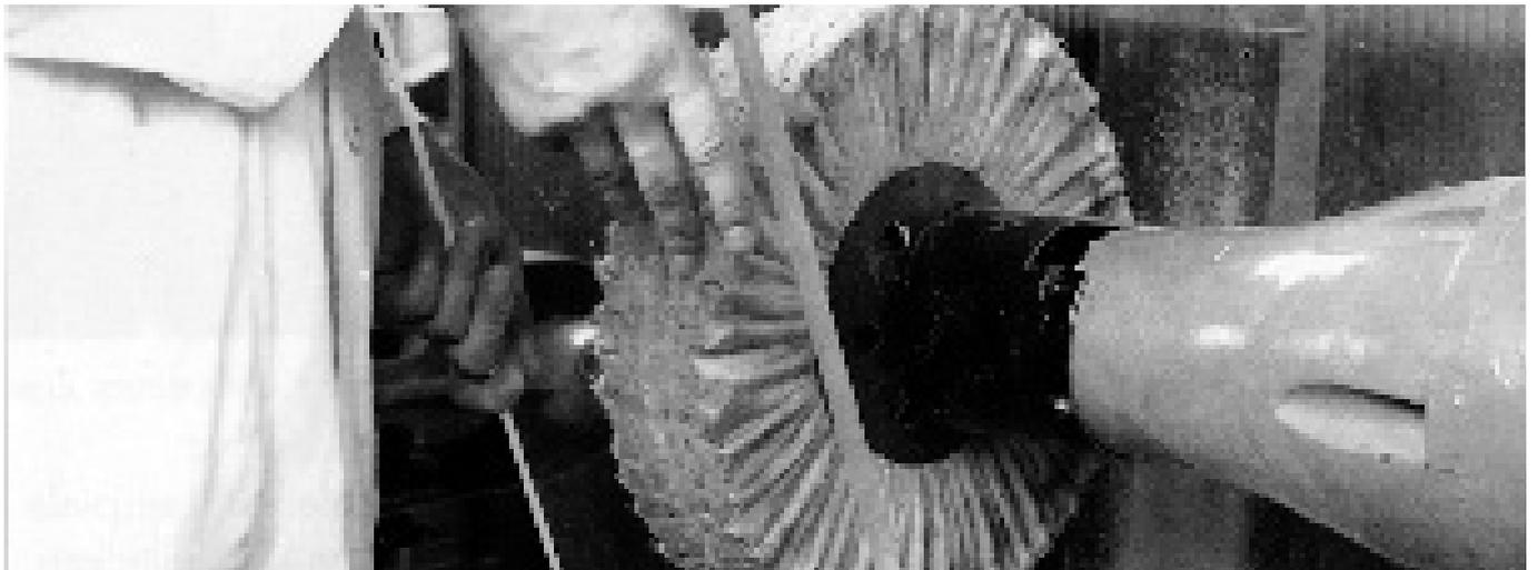
Abb. 40: Polieren an der Stoffschwabbelscheibe
