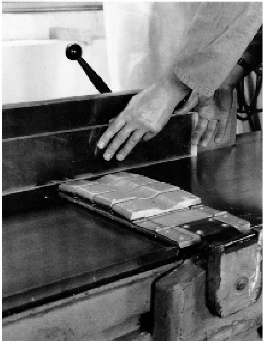
Abb. 36: Glätten der Kanten mit Abrichthobel
