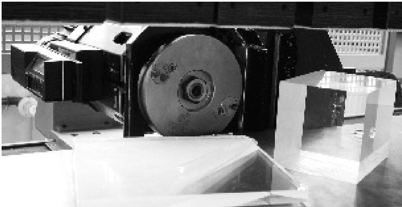
Abb. 41: Diamantpolieren
