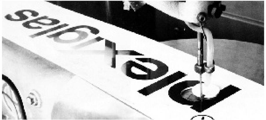
Abb. 9: Schwingsäge schneidet Schriftzug PLEXIGLAS®
